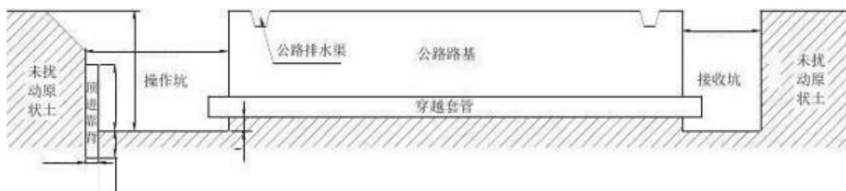
图 3.3-3 穿越道路施工作业示意图
