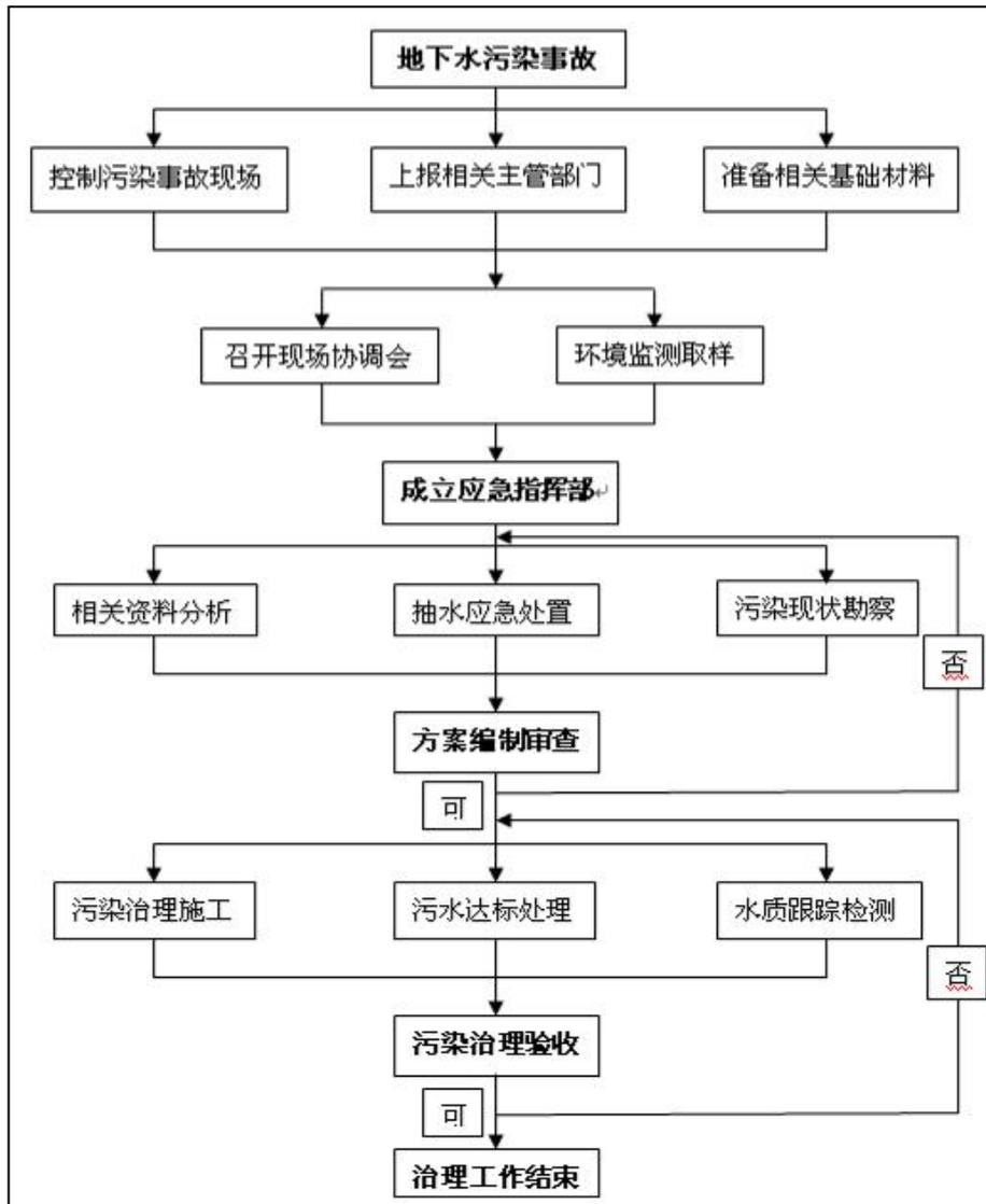
图 6.2-1 污染应急治理程序框图
