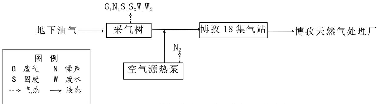
图 3.3-7 井场油气开采及集输工艺流程图
